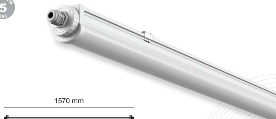
Luminaire étanche technique haute performance en polycarbonate et fixation en inox. Il est équipé d'un câblage traversant pour passage en coupure et de borniers de connexion rapide et automatique. Sa fixation coulissante en fait le produit idéal pour la rénovation, sa durée de vie et sa garantie de 5 ans sont des atouts considérables pour les projets tertiaires et industriels.
